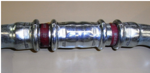
Abb. 8 (Nach der Prüfung) Nahansicht Verbindung C-Stahl
