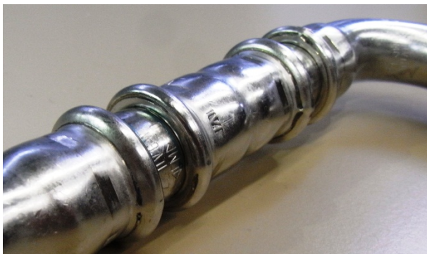
Abb. 10 (Nach der Prüfung) Nahansicht Verbindung Edelstahl
