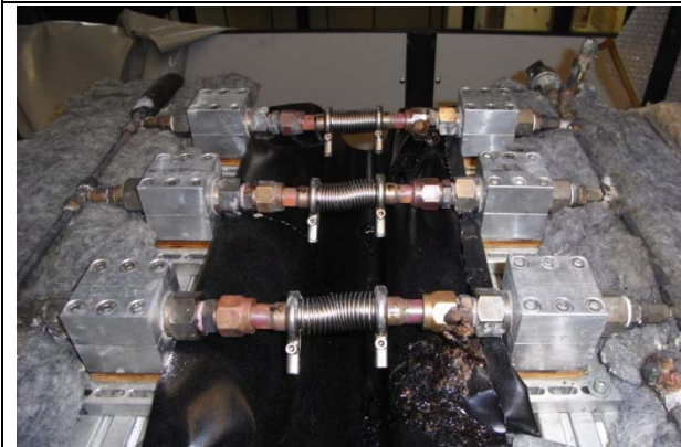
Abb. 3: (Nach dem Test) Alle Kompensatoren sind dicht. Die auf dem Bild sichtbare, ausgetretene Flüssigkeit ist vom Prüfstand und hat keine Bedeutung auf das Prüfergebnis.
