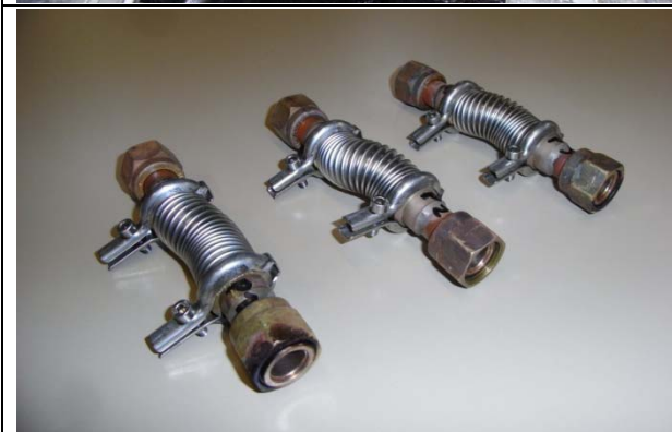
Abb. 4: (Nach dem Test) Trotz den zum Teil erheblichen Deformationen sind alle Teile dicht und unbeschadet.
