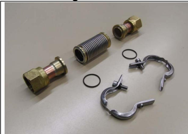
Abb. 1: (Vor dem Test) Verbindungssystem vor der Montage. Die Verschraubung ist Teil der SPF Prüfeinrichtung
