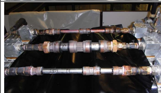
Abb. 8: (Nach dem Test) Keine Undichtigkeiten
