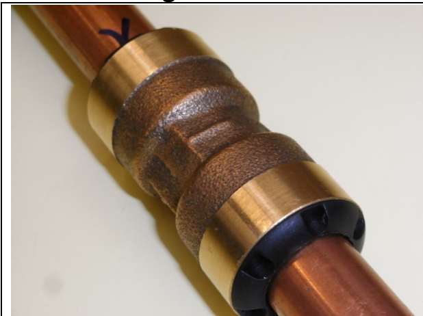
Abb. 4 (Vor dem Test) Detailansicht Steckverbindung Kupferrohr 18mm x Fitting Rotguss
