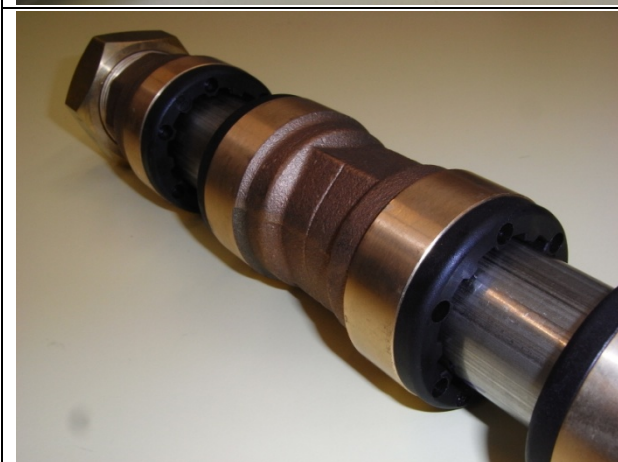
Abb. 6 (Vor dem Test) Detailansicht Steckverbindung Edelstahlrohr 35mm x Fitting Rotguss
