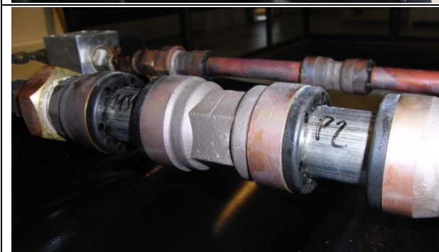
Abb. 9: (Nach dem Test) Nahansicht einer Edelstahl Verbindung nach dem Test.
