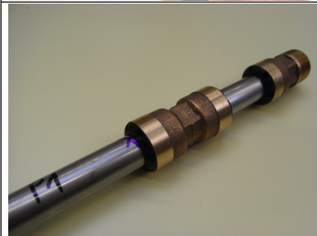
Abb. 5 (Vor dem Test) Detailansicht Steckverbindung Edelstahlrohr 18mm x Fitting Rotguss
